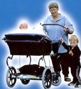
Baby-Power El-drevet hjælpemotor, der, sammen med udskiftning af hjulsæt ændrer tvillinge-barnevognen til et let håndterligt køretøj.
